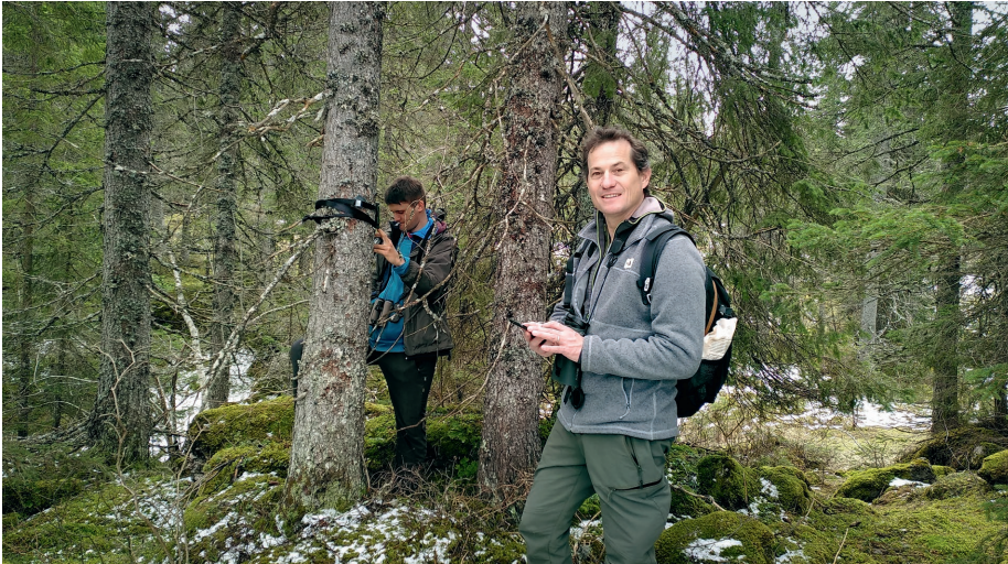
Der Zivildienstleistende Ruben Lippuner hängt im Waadtländer Jura einen Akustiklogger auf, während der freiwillige Mitarbeiter Florent Berney den genauen Standort mittels GPS erfasst. Foto Thomas Sattler.
