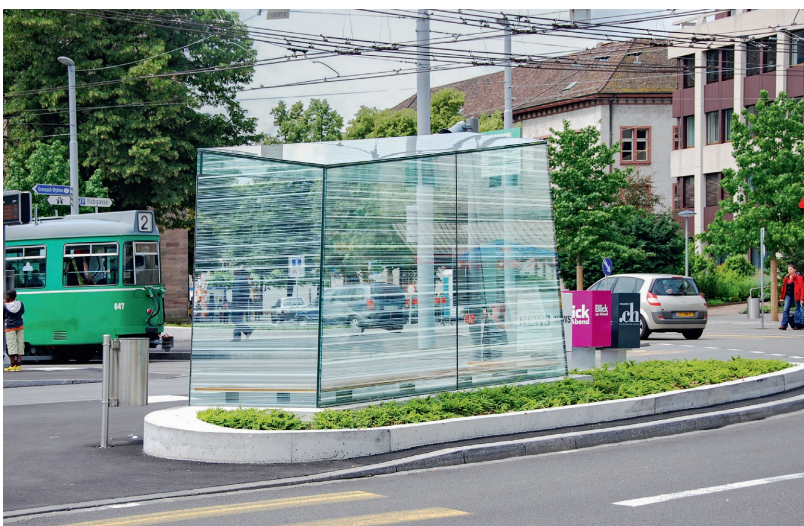
Transparente Warthäuschen erhöhen das Sicherheitsempfinden der Fahrgäste. Die weissen Linien unterschiedlicher Dicke sind wirksame Markierungen, um Vögel vor Kollisionen mit Glas zu schützen. Foto Hans Schmid.
