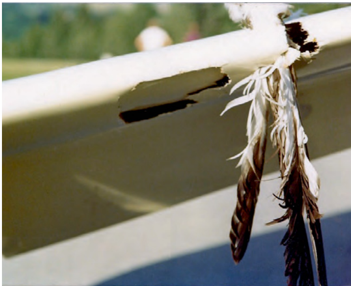
Abb. 1. Überreste eines Steinadlers und Schäden am Höhenleitwerk eines Segelflugzeugs nach einer Attacke des Adlers mit Kollisionsfolge im Juli 1975 am Sanetschpass (Kanton Bern). Aufnahme R. Notter. – Feather remains of a Golden Eagle and damages at the empennage of the glider after an attack of the eagle.
