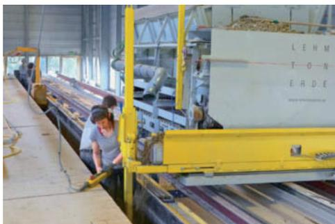
**Abb. 11.** Produktion der Lehm-Elemente in einer Fabrikhalle in Zwingen im Laufental (Kanton Basel-Landschaft). Der Lehm wird schichtweise in die Schalung gefüllt, gepresst und luftgetrocknet. Aufnahme 28. Juni 2013 (Produktion für das Kräuterezentrum Ricola in Laufen).
